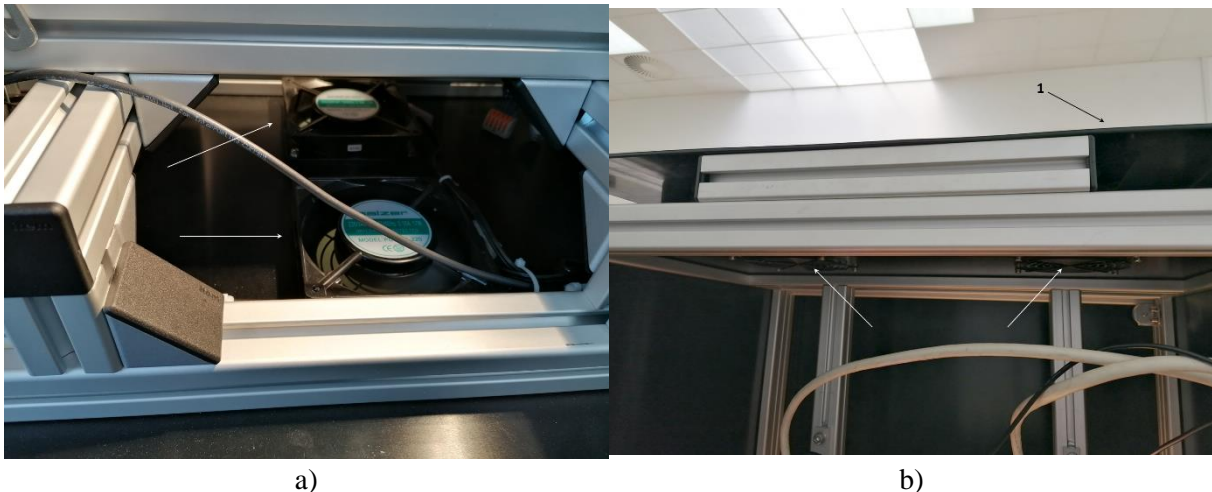
Rys. 10. Wnętrze komory wizyjnej MODOM, a) wentylatory w płycie dolnej, b) wentylatory w płycie górnej: 1 – przysłona ochronna
