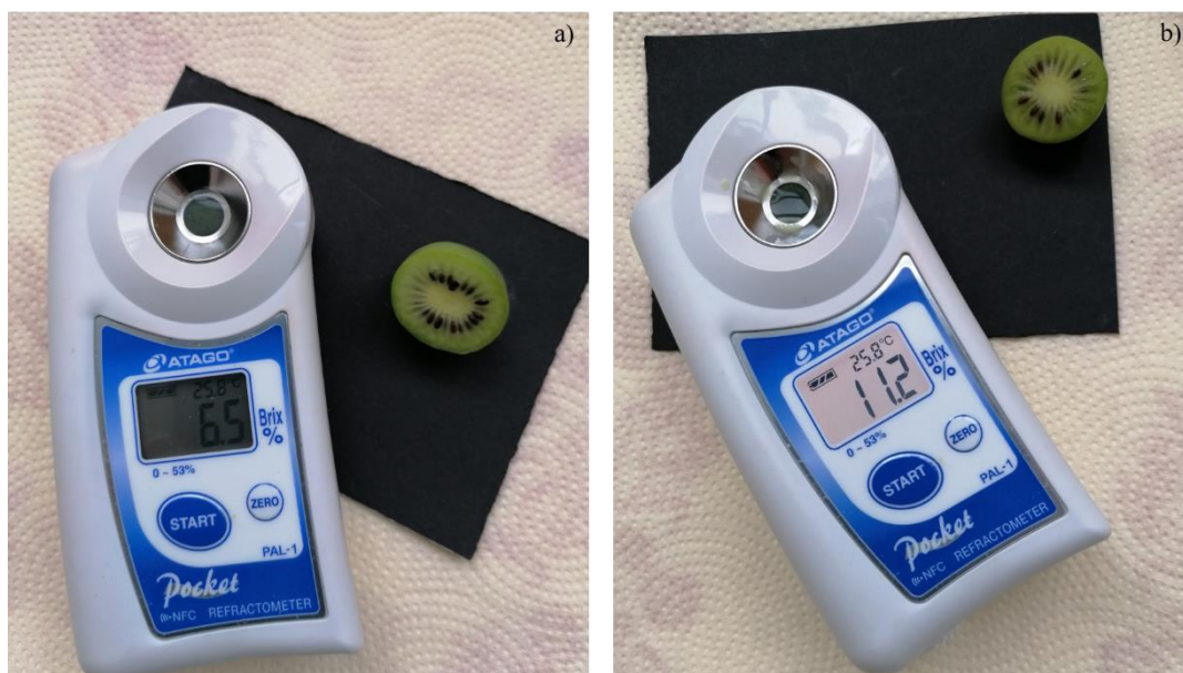
Rys. 20. Refraktometr ATAGO PAL-1, przykładowy wynik pomiaru ekstraktu a) w owocu w stanie dojrzałości zbiorczej, b) w owocu dojrzałym
